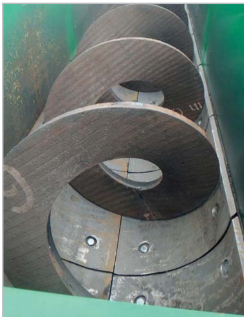
Konstrukce bezosého spirálového dopravníku Foto archiv/Rataj
